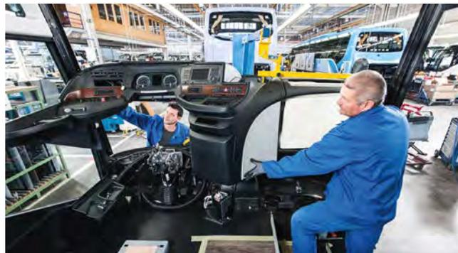
Mit einer Hebevorrichtung und viel Fingerspitzengefühl bauen zwei Mitarbeiter das Cockpit ein.
